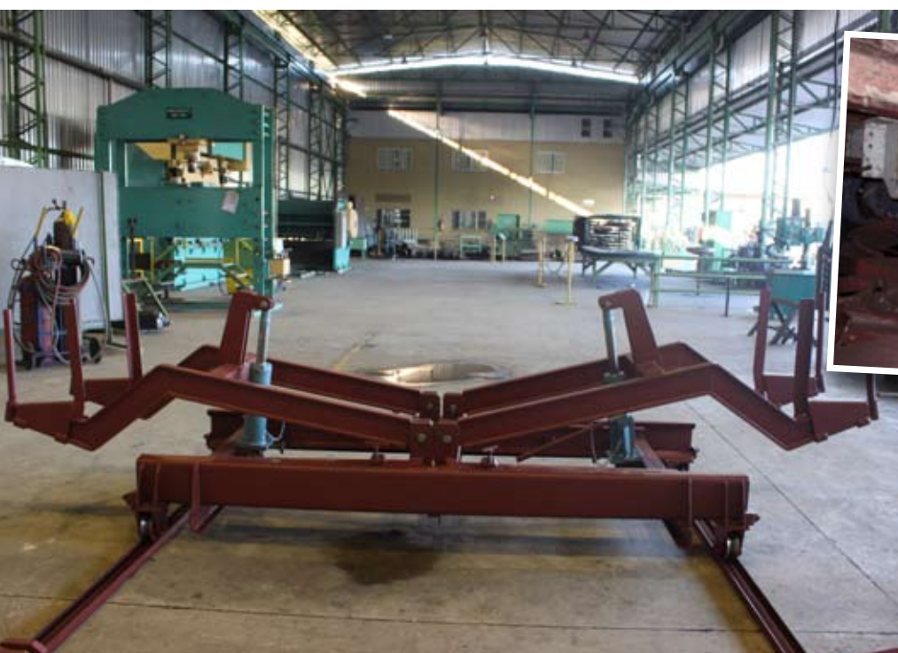
Carro desenvolvido para a troca de caixa refratária do forno de pelotização
